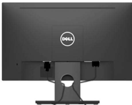
После подключения всех необходимых кабелей к монитору и компьютеру (см. раздел "Подключение монитора") организуйте кабели в соответствии с рисунком выше.
