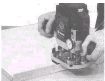
Рис. 9: Фрезерование ламината ровно с поверхностью детали. Фрезерная машина с промежуточной платой 31 503.
