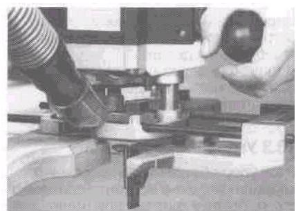
Рис. 6: Фрезерование по фигурному краю. Параллельный упор фрезерной машины с ведущим роликом 30 360
