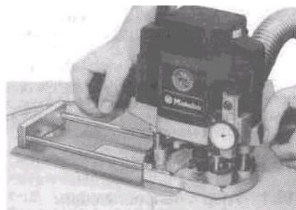
Рис. 10: Фрезерование лаза по окружности.
