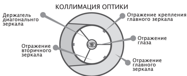
(А) Система зеркал телескопа идеально настроена, все зеркала выровнены надлежащим образом
