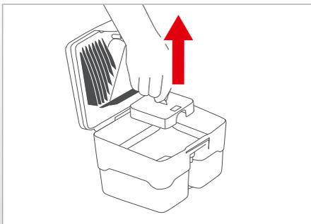
Если в резервуаре для грязной воды фильтра AQUA Vox + еще имеется грязь, то тщательно очистить под струей воды и вылить грязную воду через сливное отверстие.
