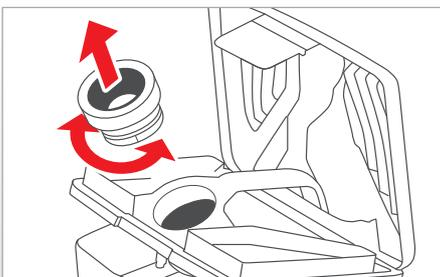
При сильном загрязнении инжектор можно снять в целях очистки, вращая уплотнение патрубков.
