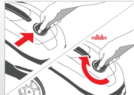
**Czyszczenie podłogi****Podłączyć rurę teleskopową z uchwytem węża ssącego.**
