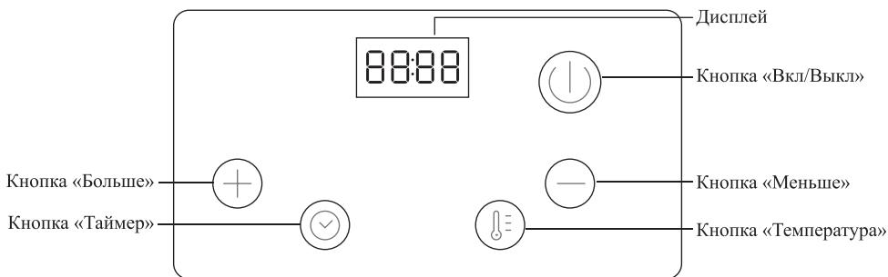
На панели управления расположены дисплей и кнопки регулирования времени и температуры, а также кнопка включения и выключения.
