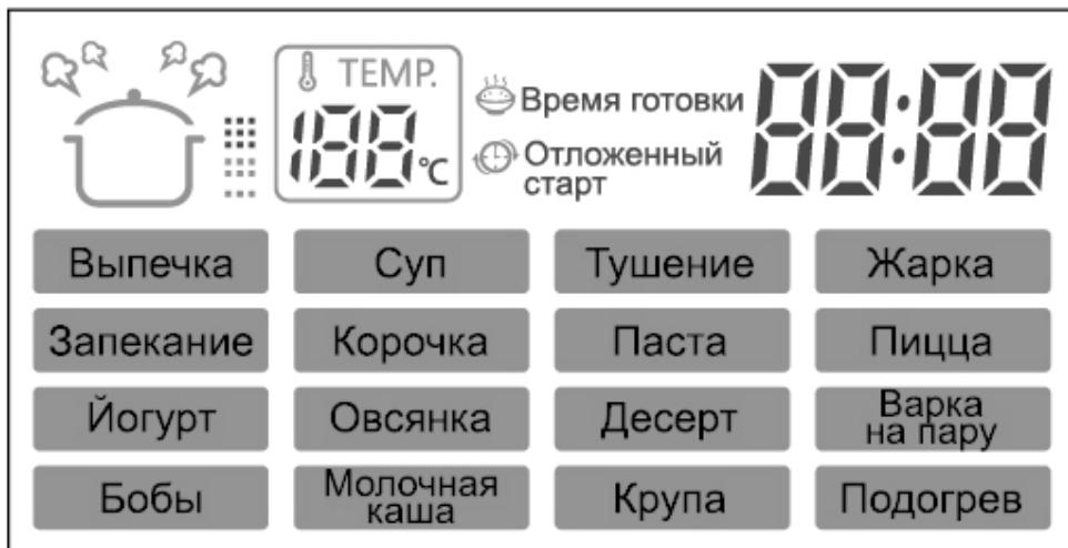
По истечении времени приготовления прибор автоматически переходит в режим поддержания температуры (за исключением программы “ЙОГУРТ”). Световой индикатор кнопка “ПОДОГРЕВ/ОТМЕНА” при этом будет гореть.
