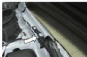
2. Установить кронштейн крыла, как показано на рисунке. Штатный болт крепления фары заменить болтом М8х30. Затянуть болт крепления крыла ключом №10 с усилием 9 Нм; болт крепления фары ключом №13 с усилием 23 Нм.
