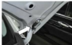
3. Открутить верхний болт крепления капота. Установить кронштейн капота, попав штифтом в технологическое отверстие. Затянуть болт ключом №12 с усилием 23 Нм.
