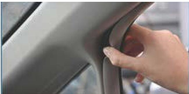
4. При установке под уплотнителями рамы двери автомобиля отогните уплотнитель.
