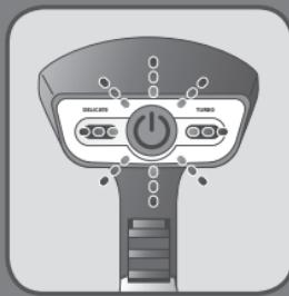
2) Tlačítko zapnutí/vypnutí pomalým blikáním signalizuje, že je spotřebič v pohotovostním režimu
