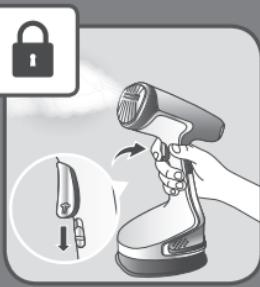
**ES** Para una salida continua de vapor, bloquear el gatillo de vapor pulsando hacia abajo el interruptor de bloqueo.
